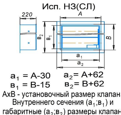
Рис.1. Установочные, габаритные и размеры внутреннего сечения клапана.
